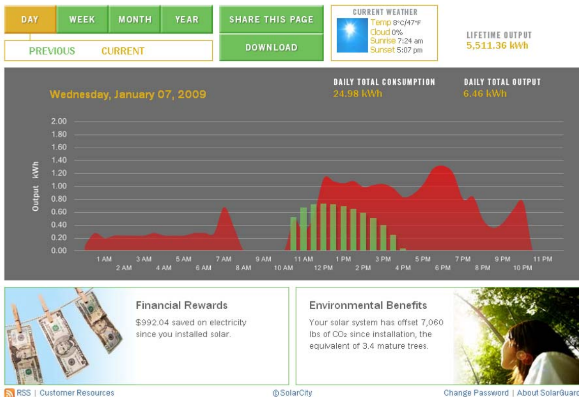
付図 4-2 SolarGuard による Web を介した太陽光発電のモニタリング画面の例
