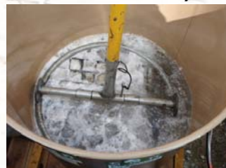
発泡スチロールの有効利用 (左: 発泡スチロール、右: SD溶剤による減容化)
