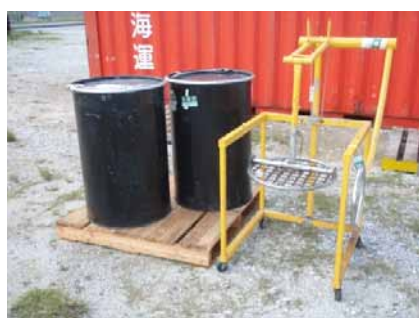
図 3.2-47 溶剤入りドラム缶と手動式ドラム缶用減容機
