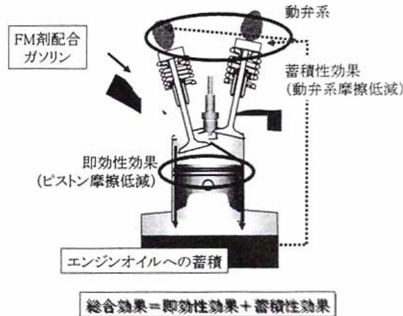
付図 13 摩擦調整剤配合ガソリンの作用機構（推定）
