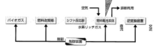
神戸生ごみバイオガス化燃料電池発電施設のシステムフロー
