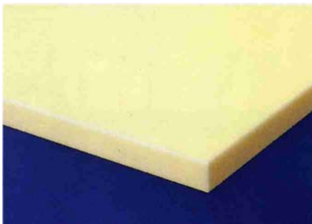
硬質ウレタンフォーム（ボード品）大きなブロックから所定の寸法に切り出した成型品 資料：日本ウレタン工業協会パンフレット
