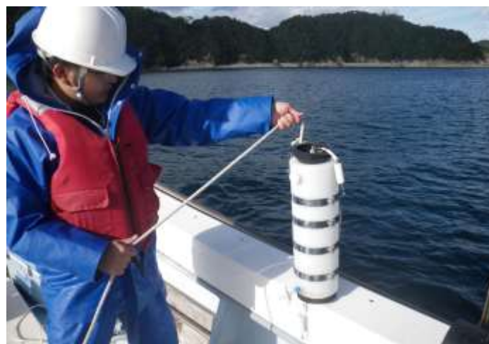
バンドーン採水器による試料採取（水質調査にも使用）
