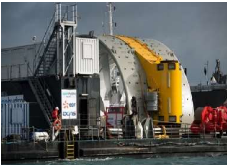
図 5.2-17 双胴設置台船により輸送中の発電システム
