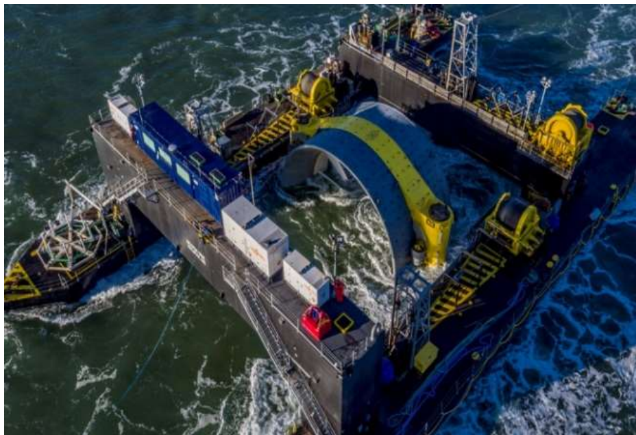
図 5.2-16 双胴設置台船にて輸送中の発電システム
