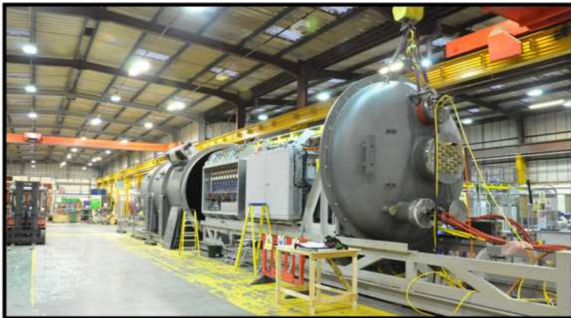
図 5.2-9 圧力容器に格納される Cape Sharp 用タービン・コントロールセンター
