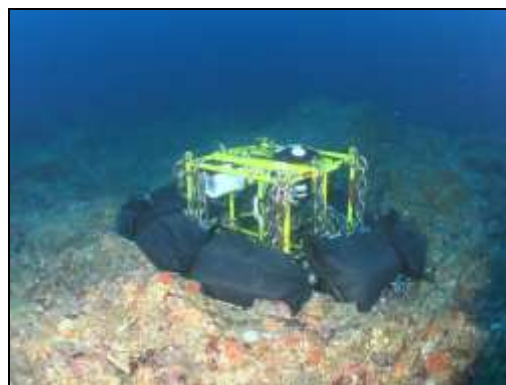
ADCP の海底設置状況 (平成 28 年 12 月 2 日)
