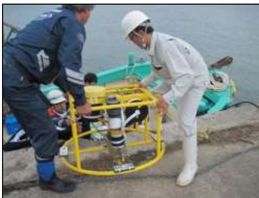
ADCP の積み込み (平成 28 年 10 月 25 日)
