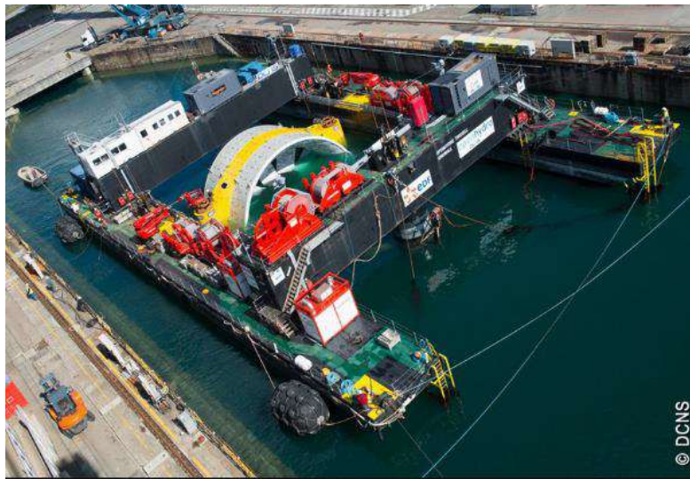
図 5. 4. 2-3 双胴船と発電機の一体化（造船所ドック内）
