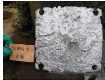
図 3-3-5 試験片①の高圧洗浄結果（秋季）左：試験前、右：1回目試験後
