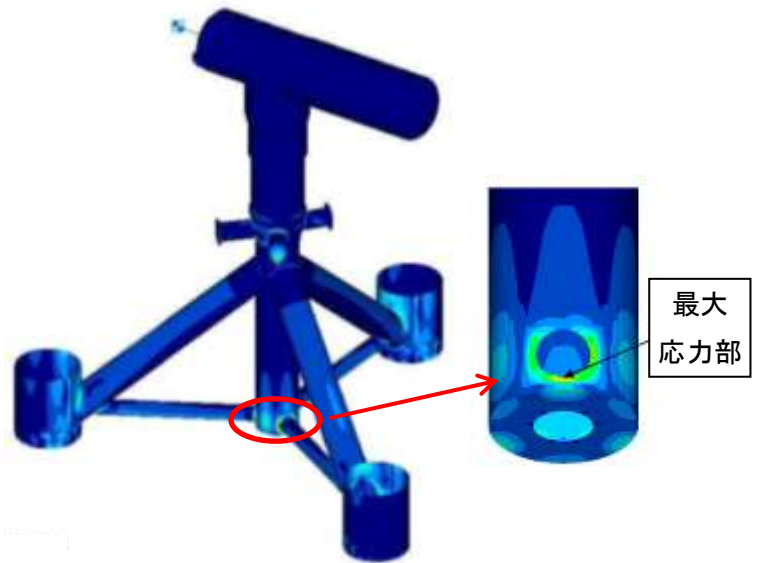
図 5-1-6 解析結果（ミーゼス応力）
