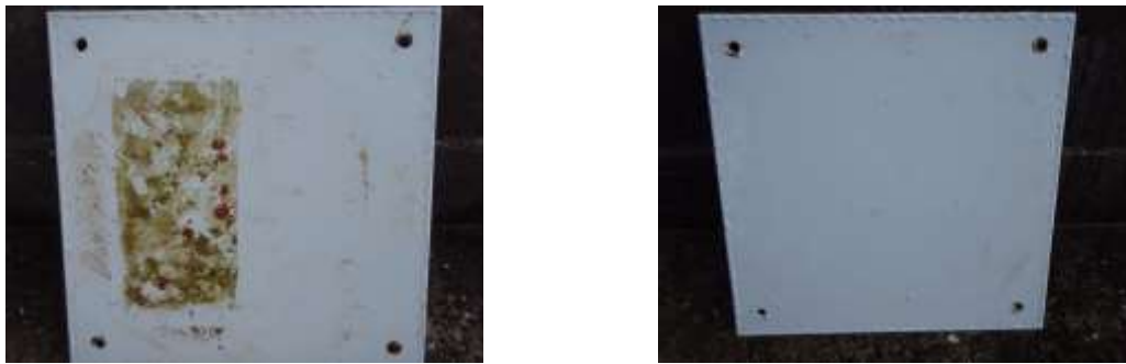
図 3-3-5 試験片⑤の高圧洗浄結果（夏季）左：試験前、右：1回目試験後
