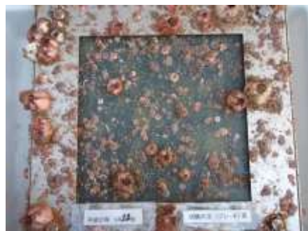
図 3-3-3 試験片③（ブレード塗料無）の生物付着状況（夏季）左：表面、右：裏面
