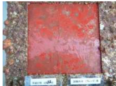
図 3-3-3 試験片④（ブレード防汚塗料有）の生物付着状況（夏季） 左：表面、右：裏面
