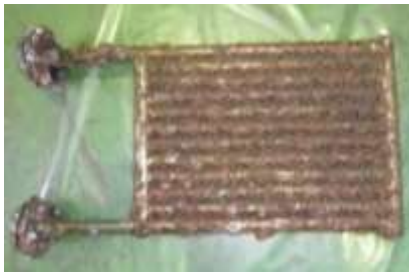
図 3-3-3 試験片⑥（着脱部二重円筒管）の生物付着状況（秋季）左：外筒、右：内筒
