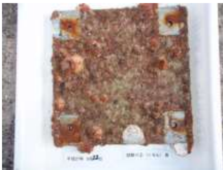
図 3-3-3 試験片②（ナセル塗料有）の生物付着状況（夏季）左：表面、右：裏面
