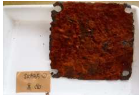
図 3-3-3 試験片①（ナセル塗料無）の生物付着状況（秋季）左：表面、右：裏面
