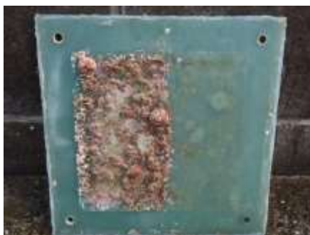
図 3-3-5 試験片③の高圧洗浄結果（夏季）左：試験前、右：3回目試験後
