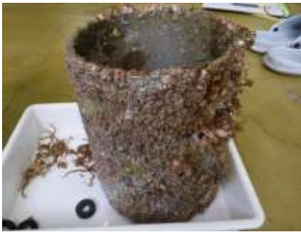
図 3-3-3 試験片⑥（着脱部二重円筒管）の生物付着状況（秋季）左：外筒、右：内筒
