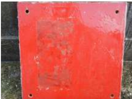
図 3-3-5 試験片④の高圧洗浄結果（夏季）左：試験前、右：1回目試験後
