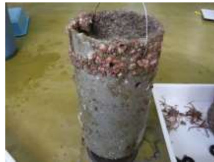
図 3-3-3 試験片⑥（着脱部二重円筒管）の生物付着状況（秋季）左：外筒、右：内筒
