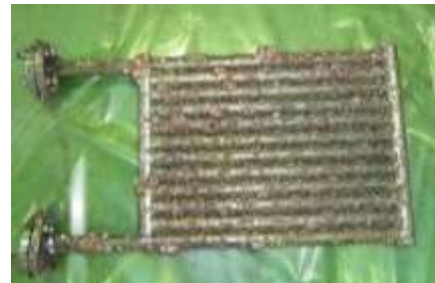
図 3-3-3 試験片⑥（着脱部二重円筒管）の生物付着状況（秋季）左：外筒、右：内筒
