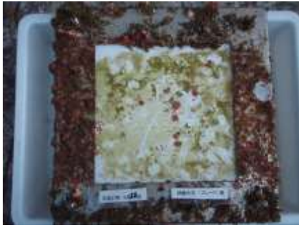
図 3-3-3 試験片⑤（ブレード防汚塗料有）の生物付着状況（夏季） 左：表面、右：裏面
