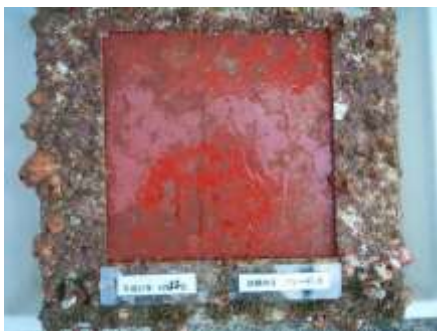
図 3-3-3 試験片④（ブレード防汚塗料有）の生物付着状況（夏季） 左：表面、右：裏面
