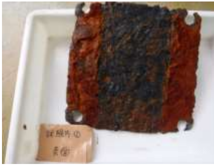
図 3-3-5 試験片①の高圧洗浄結果（秋季）左：試験前、右：1回目試験後
