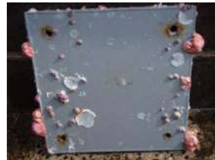
図 3-3-5 試験片②の高圧洗浄結果（夏季）左：試験前、右：3回目試験後
