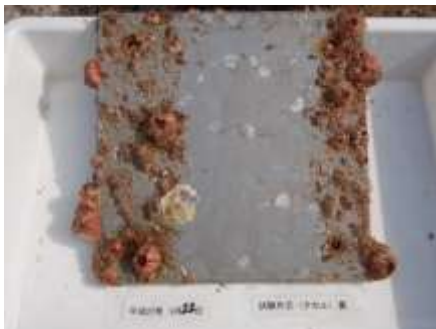
図 3-3-5 試験片②の高圧洗浄結果（夏季）左：試験前、右：3回目試験後
