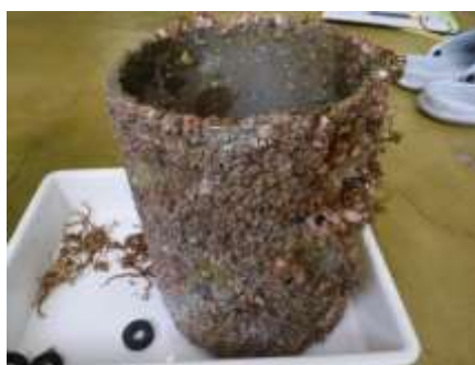
図 3-3-6 試験片⑥（着脱部二重円筒管）の生物付着状況（秋季）左：外筒、右内筒
