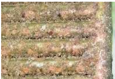
図 3-3-3 試験片⑦（熱交換器）の生物付着状況（夏季）左：表面、右：裏面
