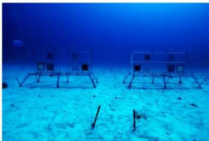
図 6-5-7 生物付着影響確認試験
