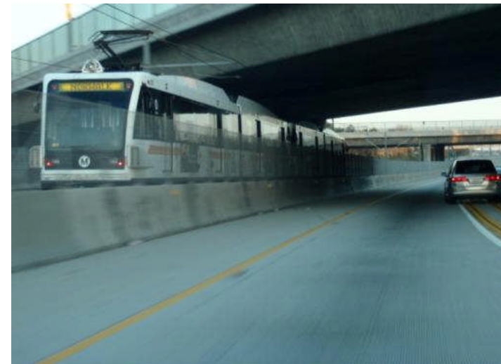
ロサンジェルスでは、高速道路の中央2車線を路面電車LRTに活用
