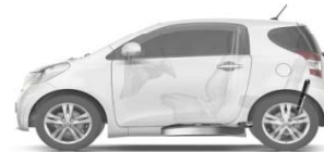
超薄型燃料タンクの床下配置
