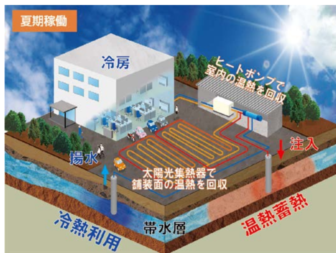
高効率帯水層蓄熱冷暖房システム模式図
