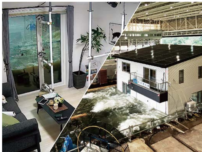
防災科研の大型降雨施設での実大耐水害実験
