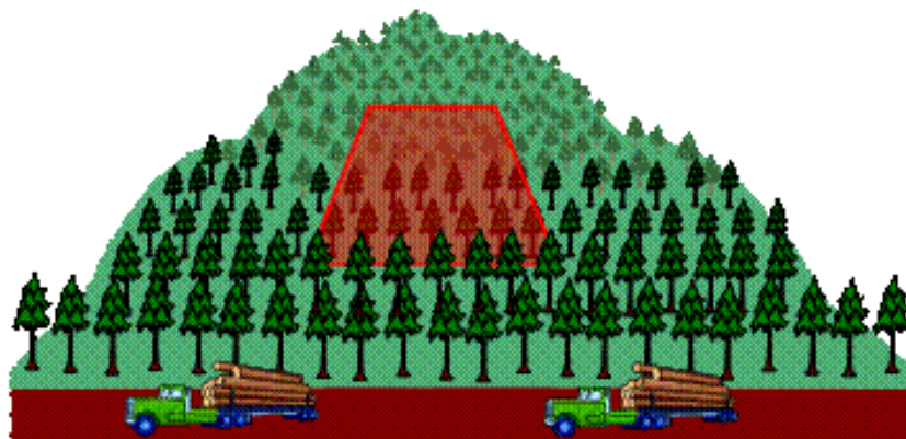
図 6 プロジェクト実施地に傾斜がある場合のモニタリングプロット設定方法
