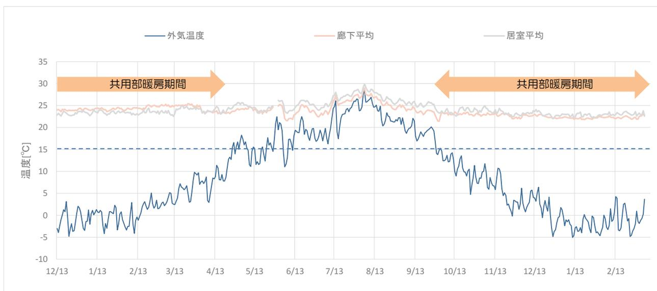
図 3.1-5 廊下、居室および外気の日平均温度推移
