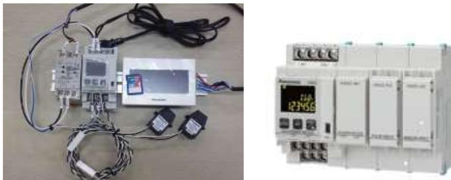
図 3.1-44 計測機器外観（左：ロガー、電力量計および周辺機器、右：電力量計単体）
