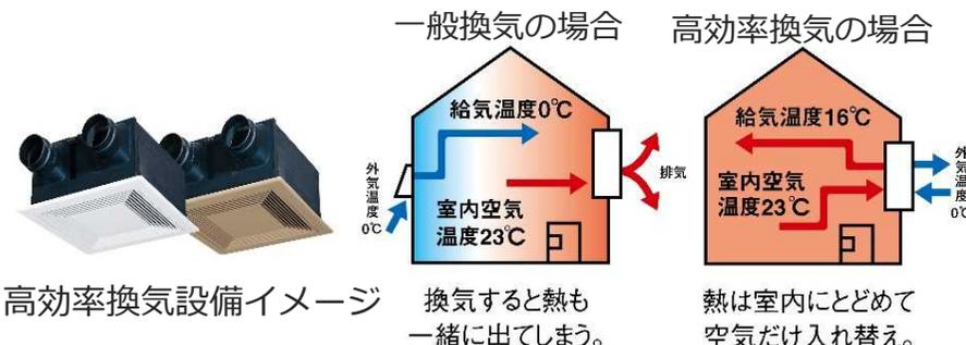
※高機能熱交換型換気設備：自然給気とファンによる排気の従来型換気システムに比べ、給気・排気ともにファンにより行うことで、確実な換気が可能、かつ熱交換により温度変化の抑制が可能。
