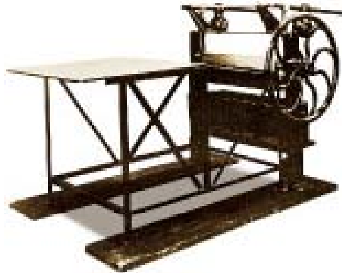
100年前 段ボール製造1号機
