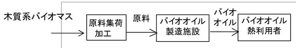
木質系バイオマスから灯油・重油の代替燃料製造
