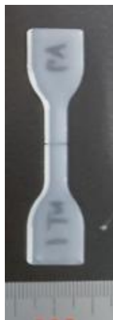
図 2-59 PP 単体の試験体
