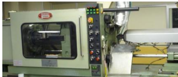
図2-85 射出成形機FE80S12ASE型（日精樹脂工業製）
