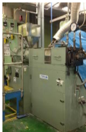
図2-84 40mm単軸押出機 (型式40M/M EXTRUDER : いすゞ化工機製)
