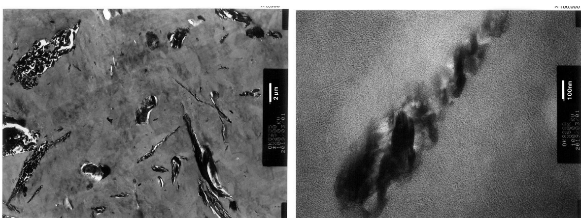
図2-105 試験体No. T4の染色TEM画像(左 \times 5000 , 右 \times 100000 )
