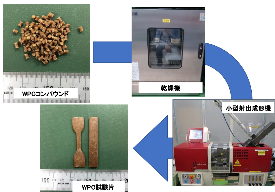
図 2-4-5 試験片作製の概要と作製された試験片の一例
