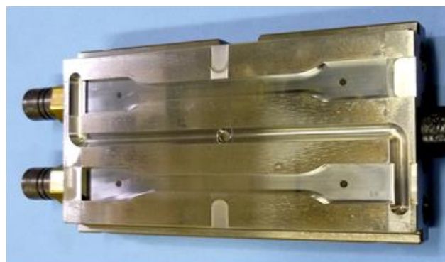
図2-86 金型：ISO多目的タイプA（AXXCON社製）
