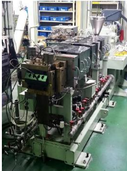
図 2 - 9 7 30mm二軸押出機 (型式TEX30 \alpha -52.5BW-11V: 日本製鋼所製)
