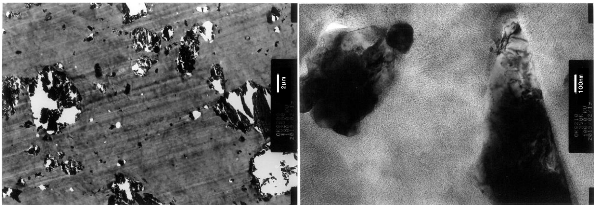
図2-94 試験体No. C1の染色TEM画像(左 \times 5000 , 右 \times 100000 )
