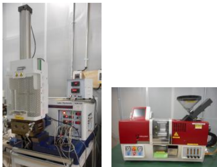
図 2-1-1 ラボプラストミル(左)、Babyplast(右)
