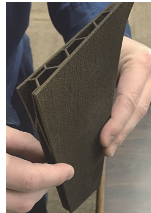
図 2.11-3 自動車部品の粉体成形品(バンパーの一部)
