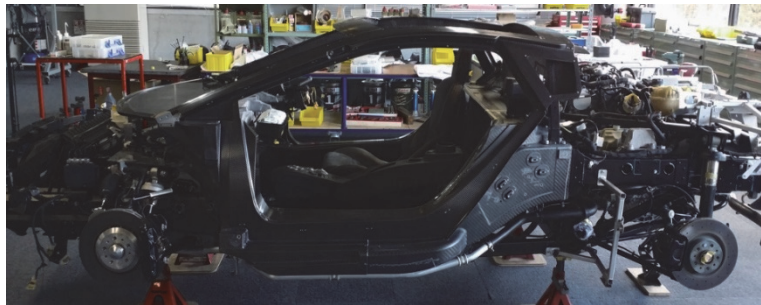
図 5.4.2 ベアシャシ完成状態
