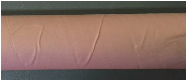
図 4.5-1 熱硬化後のシワ、浮き
