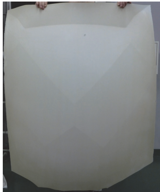
図 4.4-9 100%-CNF のボンネット形状成形体
