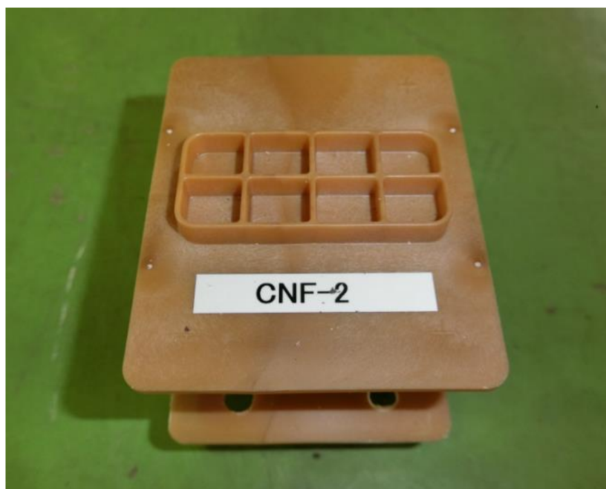
図 1.3.2.1 試験体形状(PP-CNF)
