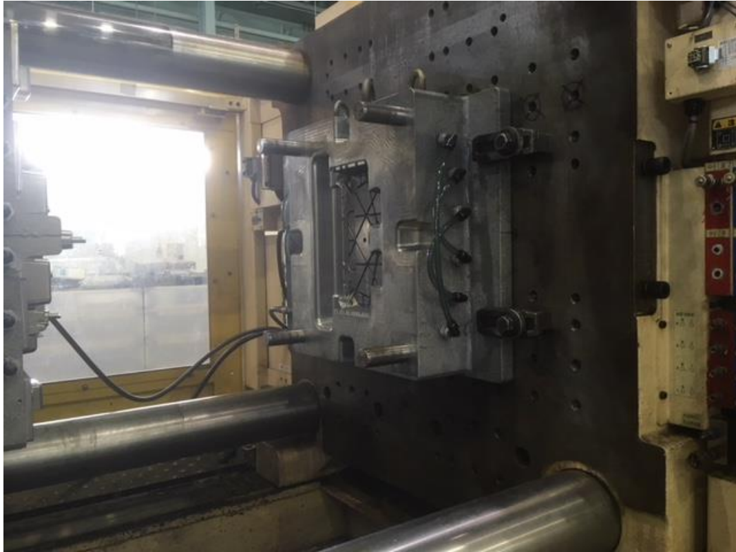
図 1.1.4.2 金型の写真 キャビティー
