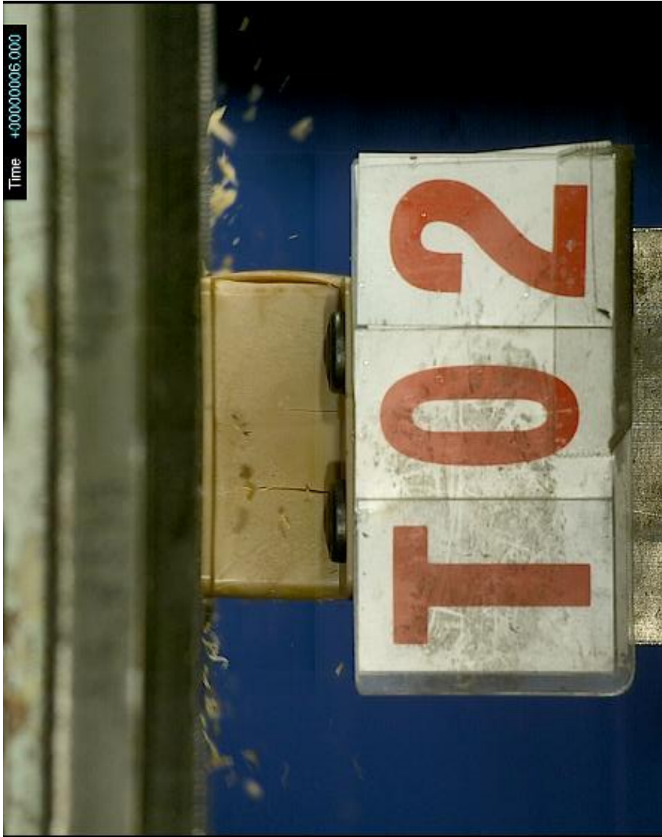
图 1.3.3.4 PP-CNF 破坏瞬间状态
