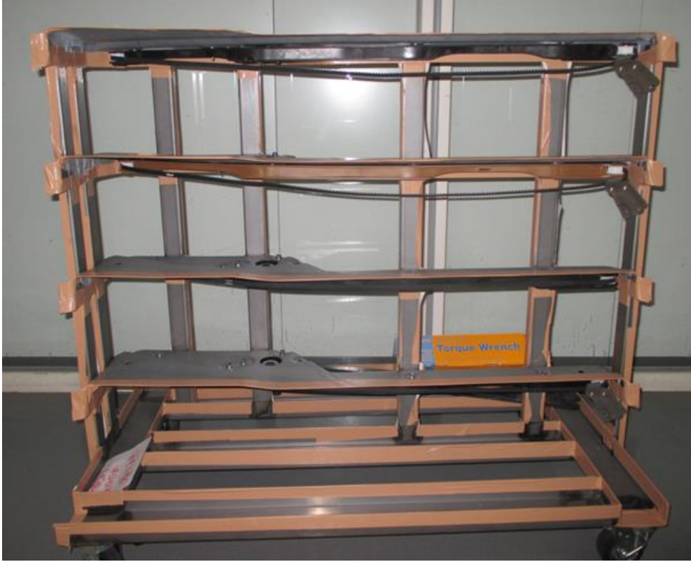
図 1.2.2.1 車両組付け想定治具
