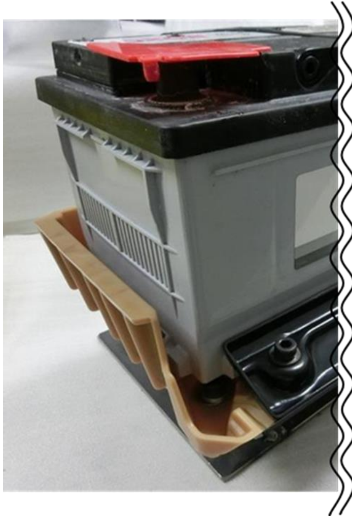
図 1.1.6.3 バッテリー組付け状態
