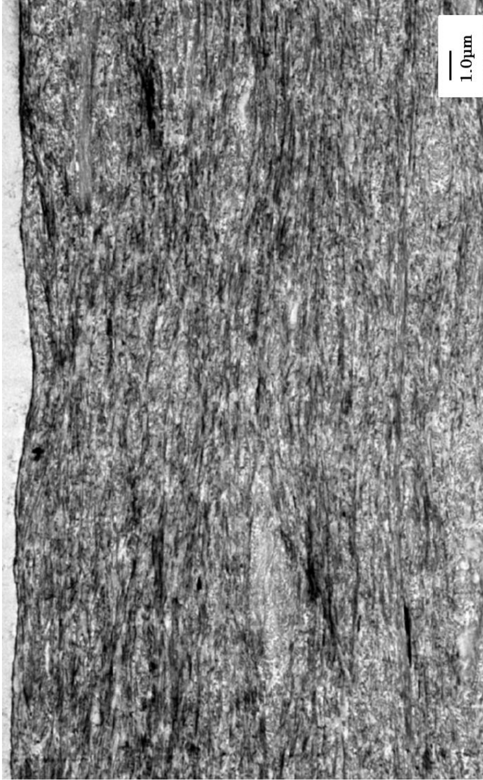
図 2.2.2.2 分散性を改善した CNFRP 中の CNF 分散状態観察結果 10,000 倍
