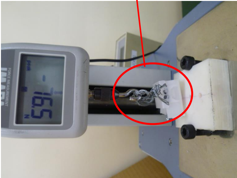
図 1.4.1.2 ロック保持力の試験方法 左：プッシュユプルゲージ、右：測定の様子
