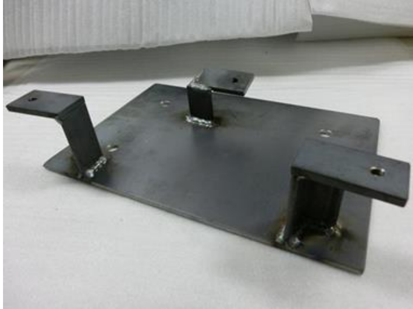
图 1.1.6.1 製品固定用治具
