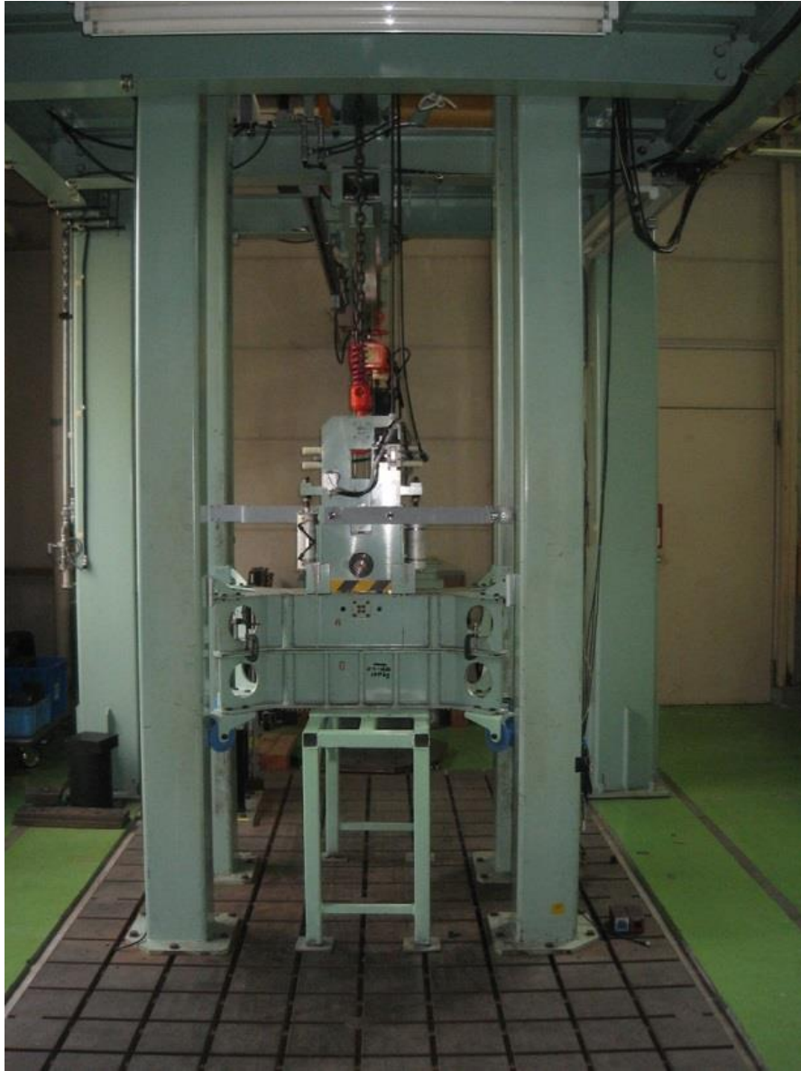
図 1.3.3.1 落錘衝撃試験機
