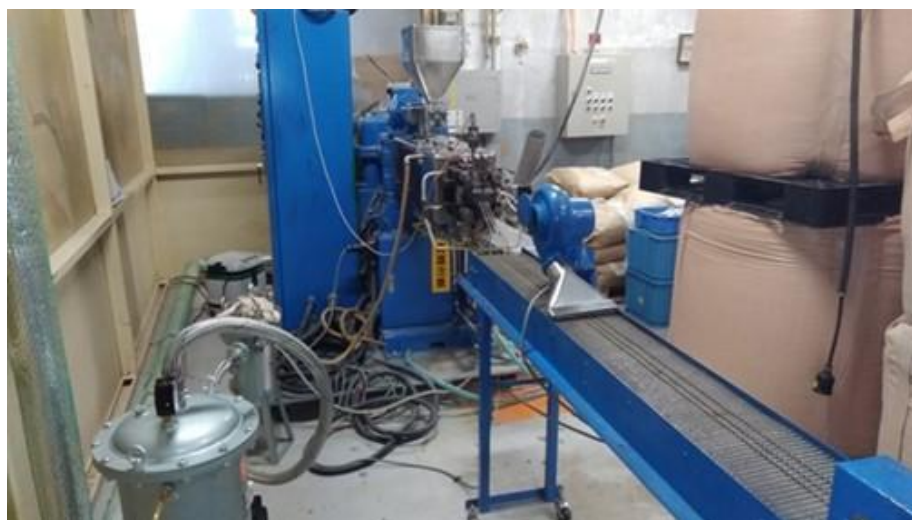
図 2-23 コンパウンド化に使用した押出成形機
