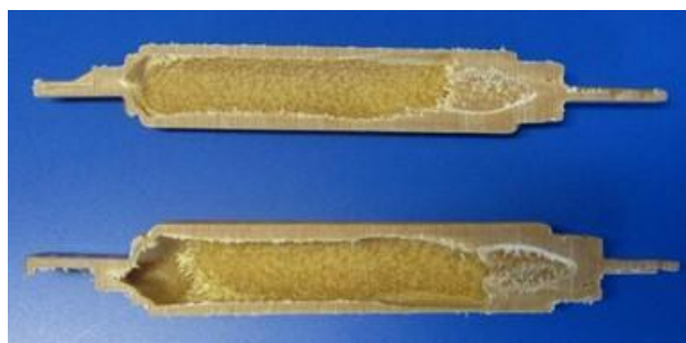
図 2-47 WPC 中空 INNER GRIP 試作品の断面
