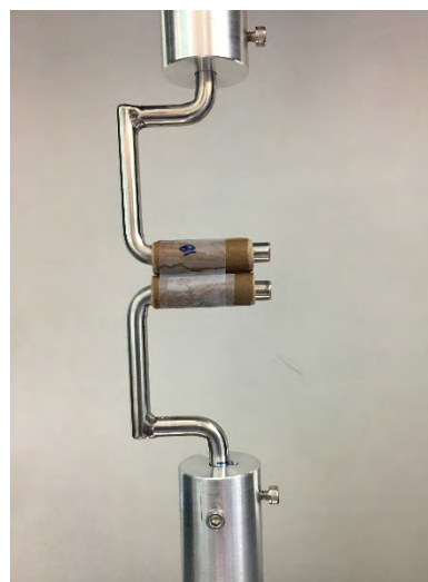
図 4.1-2 引張試験用治具と テストピース
