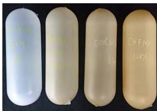
図 3.4-7 ブロー成形サンプル(CNF 配合 3 水準)
