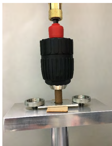
図 4.1-4 引張試験用治具と テストピース
