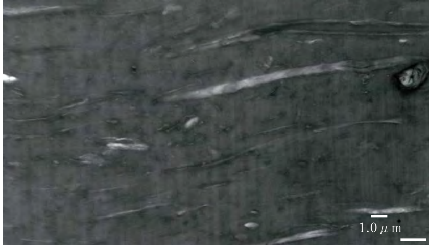
図 5.2-5 PA6+CNF 材の TEM 画像
