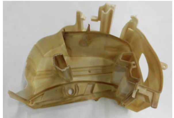
図 5.1-7 ヒーターケース発泡成形体(成形温度:210℃、PE-CNF1%)
