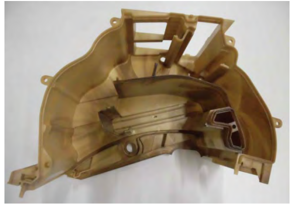
図 5.1-6 ヒーターケース発泡成形体(成形温度:220℃、PE-CNF1%)
