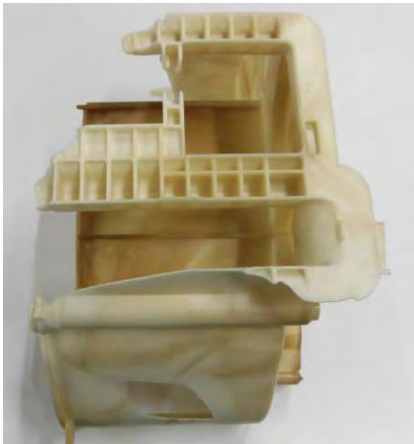
図 5.1-7 ヒーターケース発泡成形体(成形温度:210℃、PE-CNF1%)
