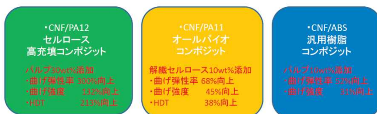
図 5-4 各樹脂とCNFの複合化による曲げ弾性率等の強化効果
