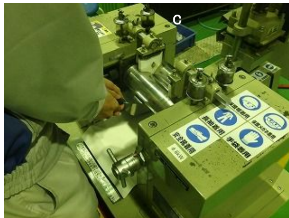
図 3-1 2 本ロール機写真 A:装置全景 B:ロール(拡大) C:樹脂混練
