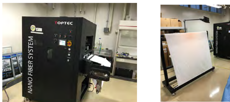
図 3-3-2 信州大学繊維学部 Fii 施設のエレクトロスピンニング装置
