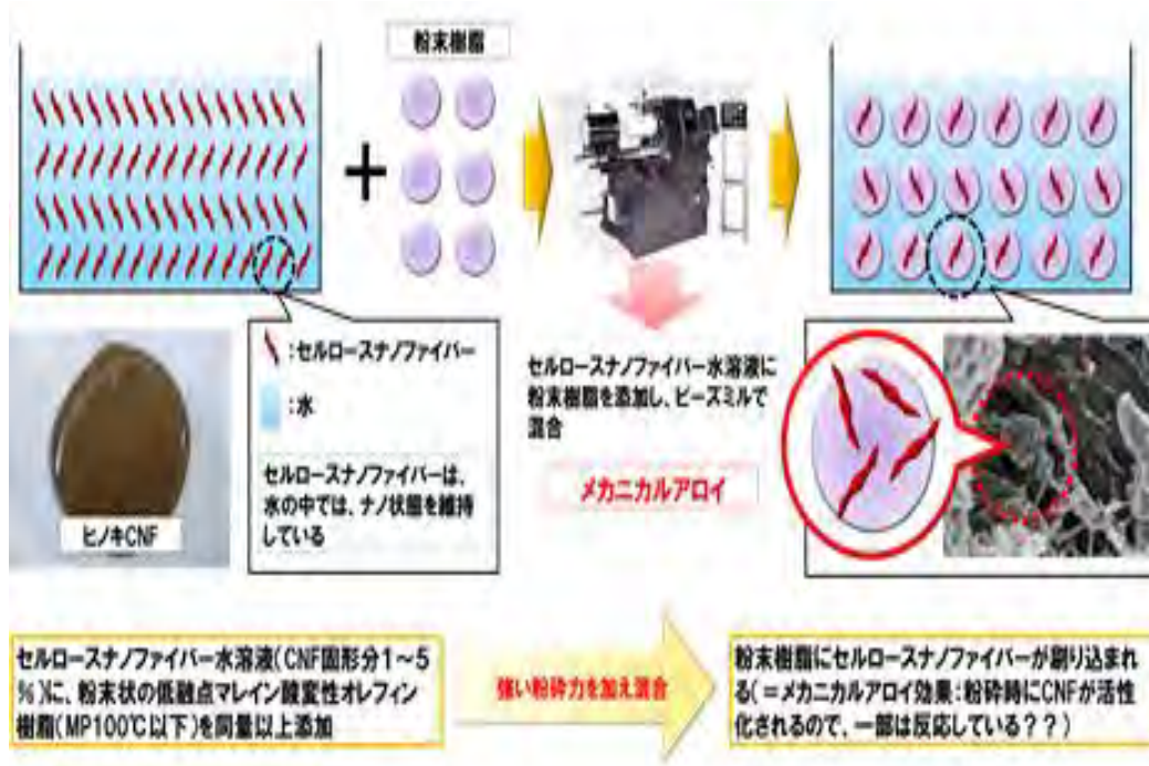
図 3-1-2 メカニカルアロイによる CNF の改質 (出典：トクラス(株))
