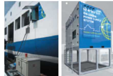
船舶側陸電受電設備
