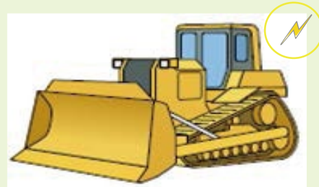
エレクトリックブルドーザ 燃費改善は約20% ▲約18トン -CO 2 /台・年
