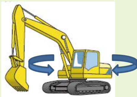
ハイブリッド油圧ショベル 燃費改善は約25% ▲約10トン -CO 2 /台・年
