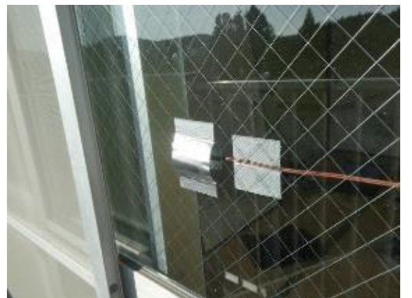
図Ⅱ-4-2-12 壁・ガラス表面温度測定 (和室1)
