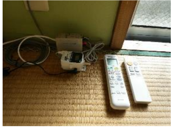
図Ⅱ-4-2-10 エアコン消費電力量計測器設置の様子 (左：エアコンとCT、右：電力量計とパルス測定器)
