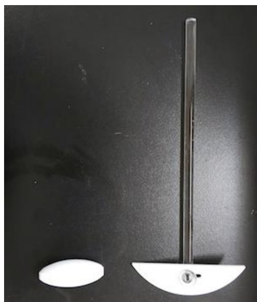
図Ⅱ-2-2-4 攪拌子（左）と攪拌翼（右）
