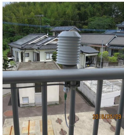
図Ⅱ-4-2-9 計測器設置の様子 (外気温湿度)
