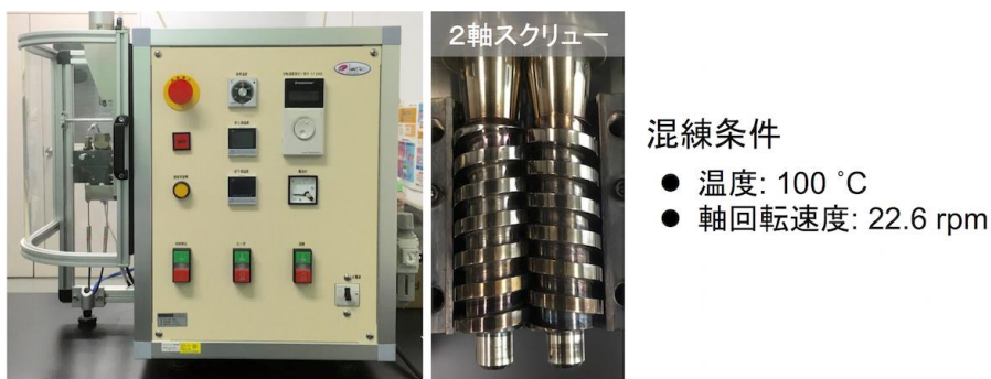
図 II-5-1-2 微量二軸混練押出機 (IMC-9B00、井元製作所製)
