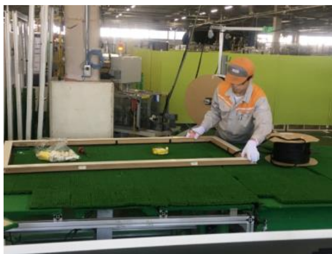
図 II-1-2-3 加工中の CNF 樹脂サッシ部材
