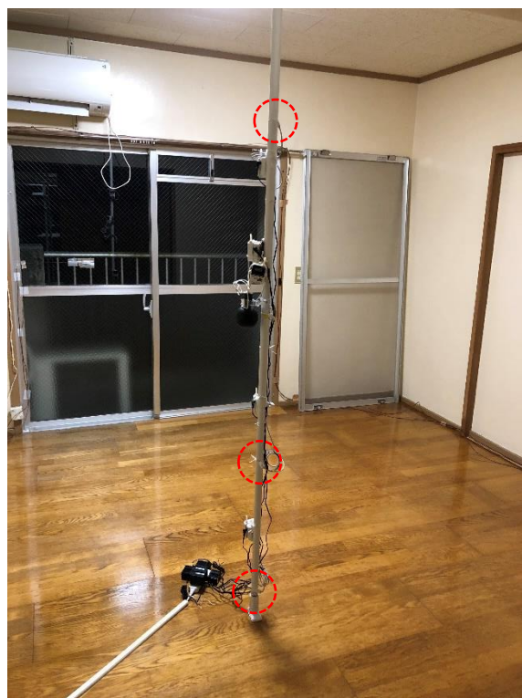
図Ⅱ-4-2-17 上下温度分布計測器設置の様子（DK）（2020年1月10日より）
