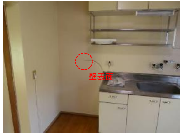
図Ⅱ-4-2-13 壁・ガラス表面温度測定 (DK)
