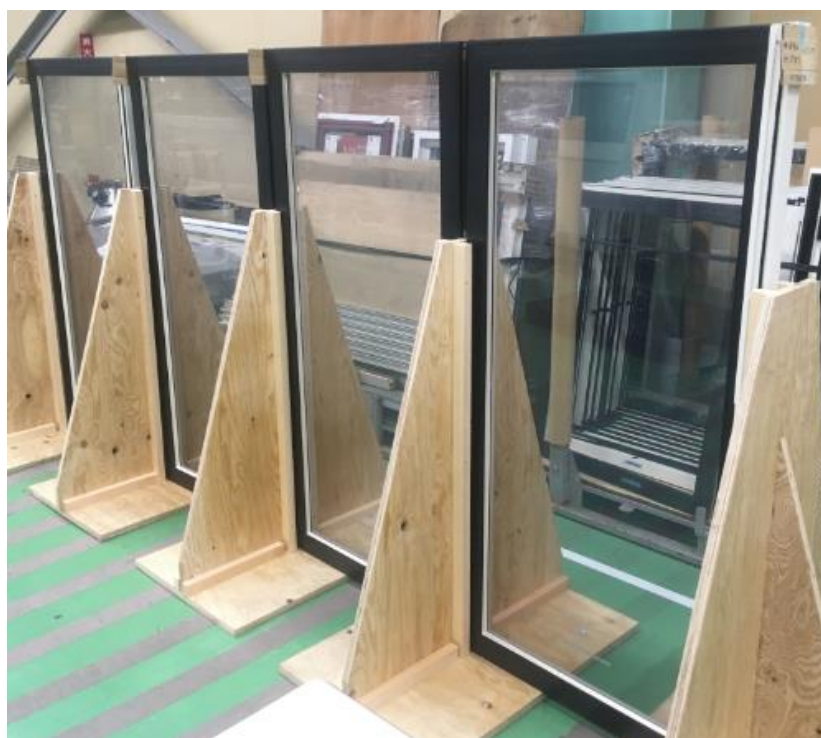
図 II-1-2-4 CNF 遮熱合わせガラス嵌めこみ完了後の CNF 樹脂サッシ障子
