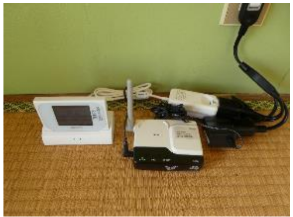
図Ⅱ-4-2-11 住宅全体消費電力量計測器 (左)、データ収集機とWifi ルーター (右)
