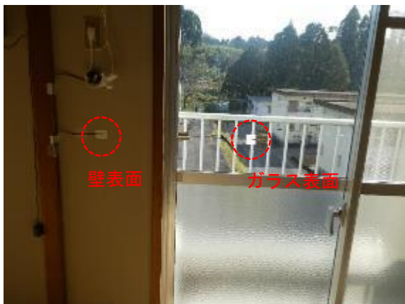
図Ⅱ-4-2-12 壁・ガラス表面温度測定 (和室1)
