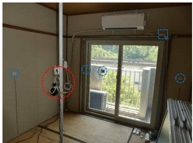
図Ⅱ-4-2-8 計測器設置の様子 (左: 1号棟DK、右: 1号棟和室3)
