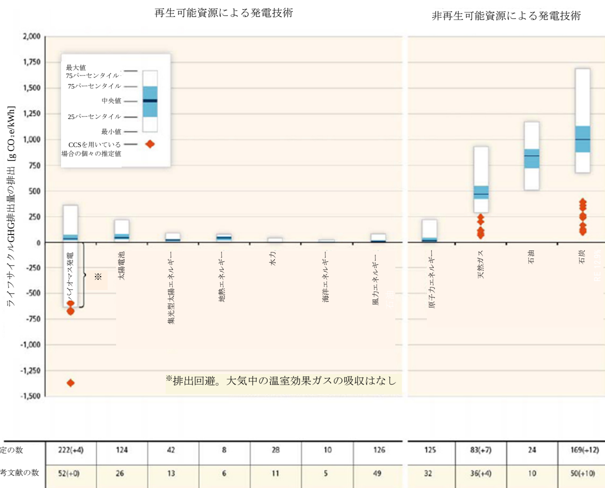
図 TS.9.4: 広範なカテゴリの発電技術に加え、二酸化炭素回収・貯留を組み合わせた一部技術におけるライフサイクル温室効果ガス排出量 (g CO 2 e/kWh) の推定。土地利用に関連する炭素ストックの正味の変化（バイオマス発電及び貯水池からの水力が主に該当する）と土地管理の影響は除外している。バイオマス発電の負の推定値 20 は、埋立処分及び副産物の残渣や廃棄物からの排出回避についての想定に基づく。レビューの参考文献及び方法は、Annex II で報告されている。推計の数が参考文献の数を上回るのは、多くの研究で複数のシナリオを検討しているためである。丸括弧内に報告した数は、二酸化炭素回収・貯留を併用した技術を評価した追加の参考文献及び推定値に関するものである。分布情報はライフサイクル評価関連の文献から現在入手出来る推計にするものであるが、あらゆる普及の条件の検討には、基礎となる理論的極限值、実際の極限值（practical extrema）、あるいは実際の中心となる傾向には必ずしも関連しない [図 9.8]。
