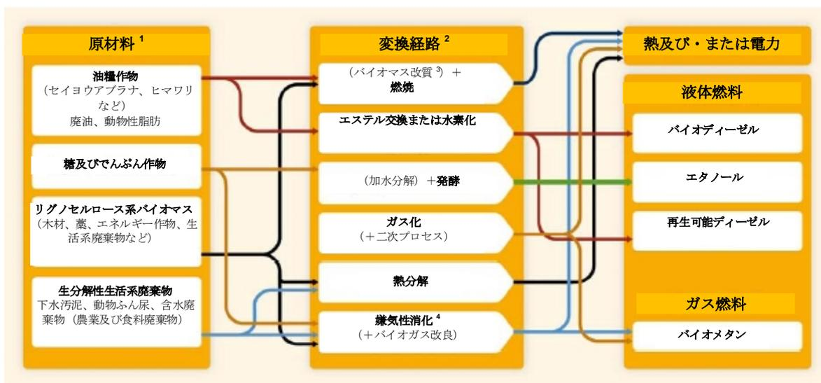
図 2.6: 商業用バイオエネルギー経路の概略図（IEA, Bioenergy, 2009 を改変）。
