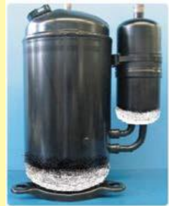
【圧縮機及び アキュムレーター底部の霜付き】
