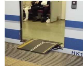
写真上左 : 駅コンコースにてギアブレイキ台車移動中 写真上右 : 車内にてギアブレイキ台車固定中 写真下 : 駅ホームにてポータブルスロープ (現地調査にてLCSPA撮影)
