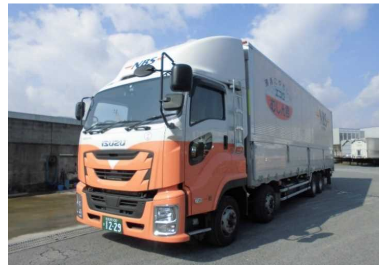
大型トラック (4軸低床大型ウイング車)
