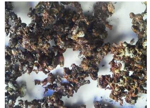
クリンカ（灰の成分が溶融し、固まったもの） ※バイオマスボイラー普及促進会Webページより
