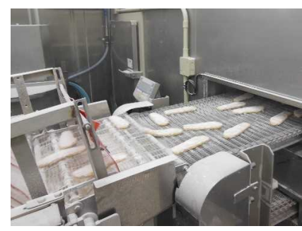
製造ライン 写真右側内部において冷風を当て、凍結させている。
