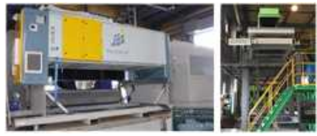
導入選別機の外観と設置状況 (画像提供: (株)中村環境)
