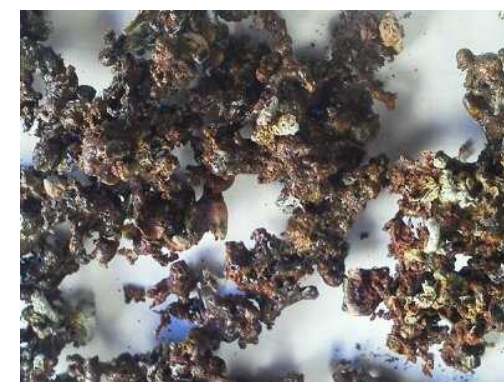
クリンカ（灰の成分が溶融し、固まったもの） ※バイオマスボイラー普及促進会Webページより
