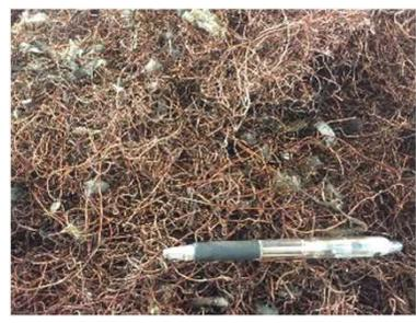
破碎後の回収素材 (銅濃縮物)
