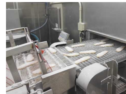
製造ライン 写真右側内部において冷風を当て、凍結させている。
