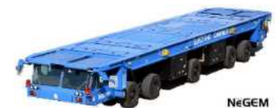
②電動型重量物搬送車両
