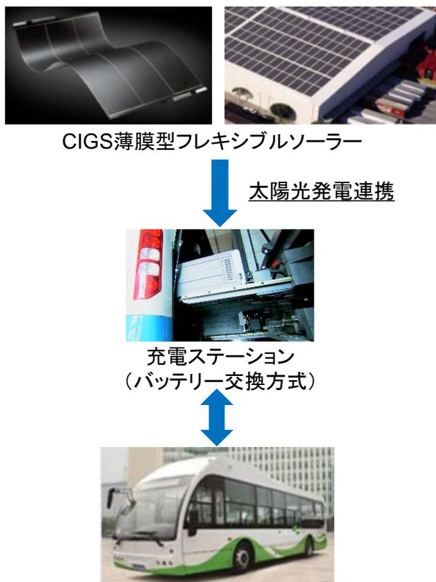
図 32 ゼロエミッション型・バッテリー交換方式 EV バスのイメージ
