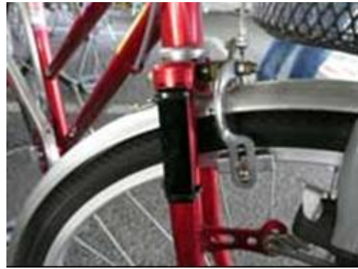
図 4-14 : 自転車用に開発した IC タグ
