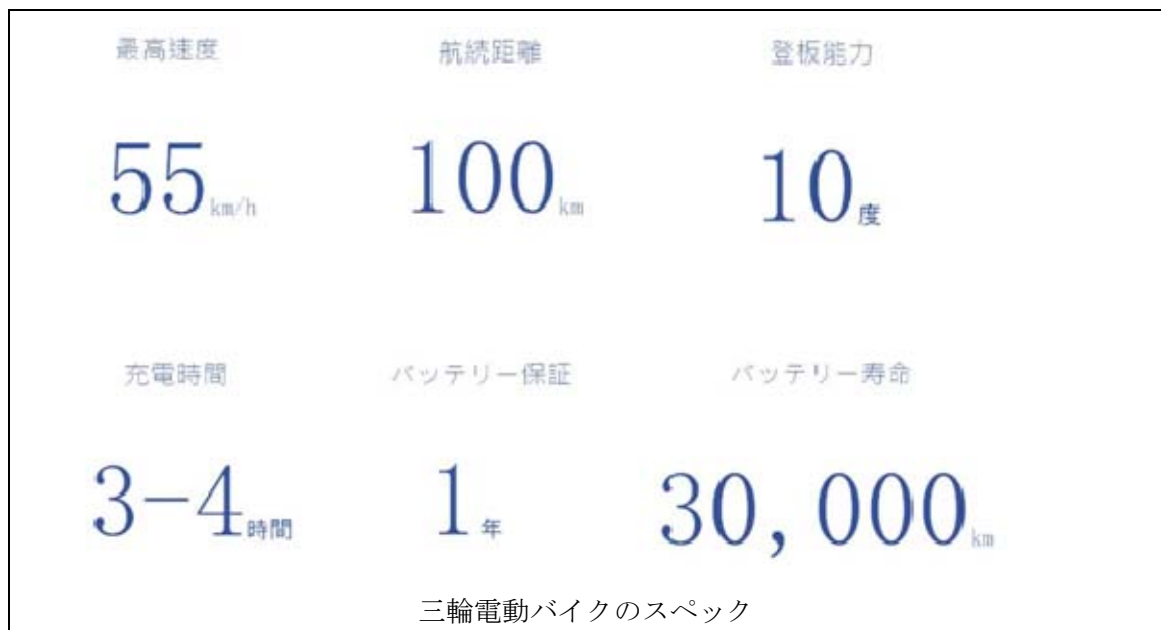
図 4-12：紹介した電動バイクの技術概要
