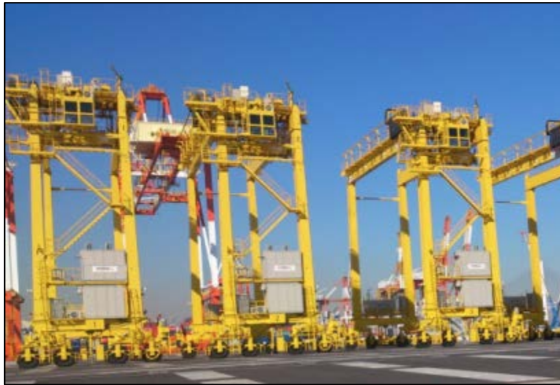
図 35 横浜港で使用されるハイブリッド RTG 下の方に設置された白っぽい箱型のものがバッテリー
