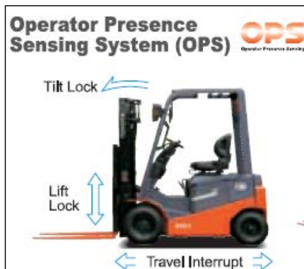
図 28 作業者搭乗検知システムのしくみ
