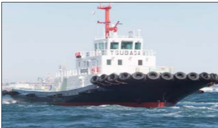
図 58 リチウムイオンバッテリー搭載タイプハイブリッドタグボート「翼」 (横浜港の例)
