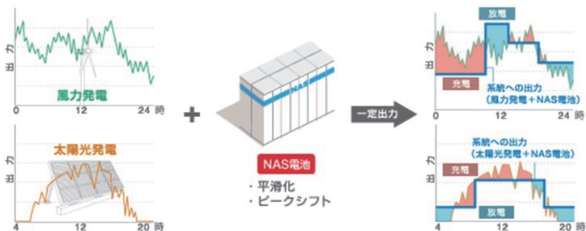
図 2-7 NAS 電池による再生可能エネルギーの安定化
