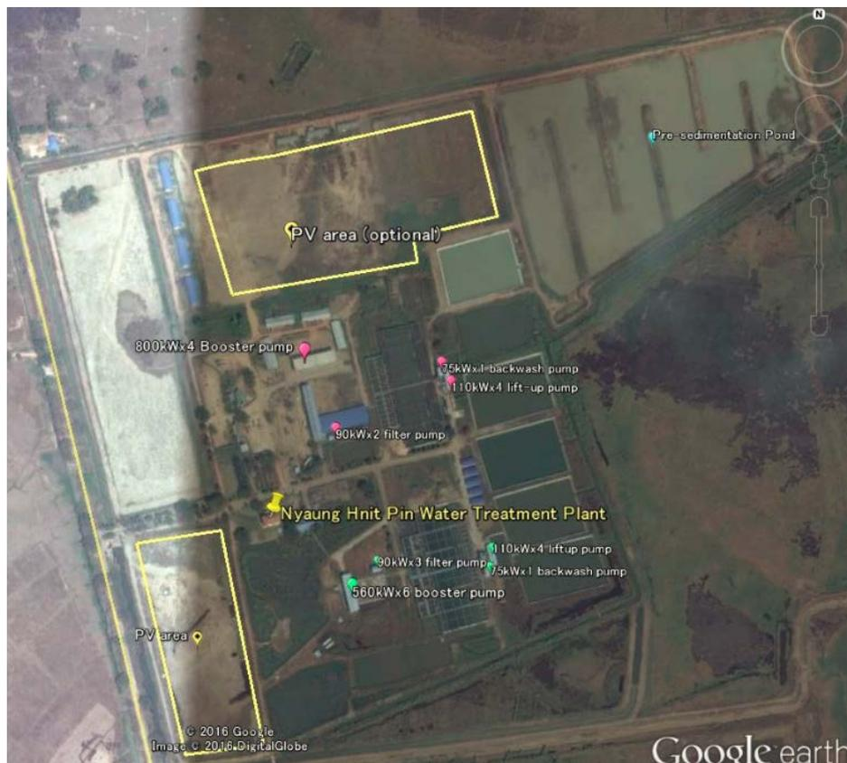
図 4-4 Nyaung Hnit Pin 浄水場とポンプおよび PV パネル位置候補
