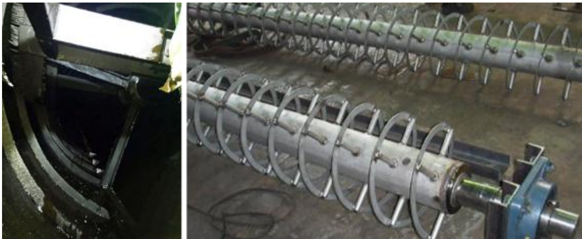
a) 導入予定装置の炉内 b) リボンスクリュー-全景（出展：有限会社トータルエンジニア Web より）
