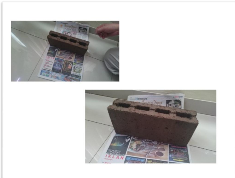
図 3-19 商材化を計画している残渣から作られる建材用ブロック(試作品)
