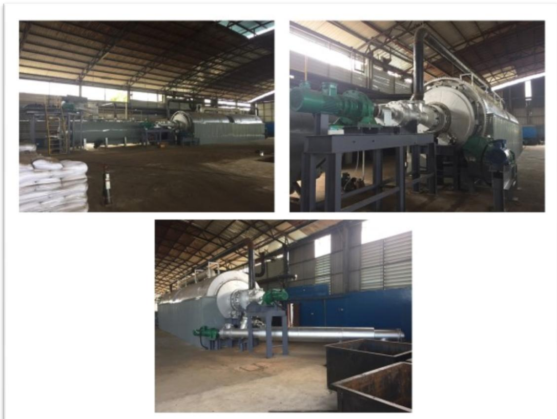
図 3-9 新しく導入予定の高効率加熱分留装置概要写真(Thermal Desorption Unit)
