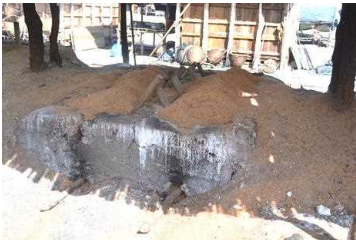
写真 オガクズを投入した製塩炉
