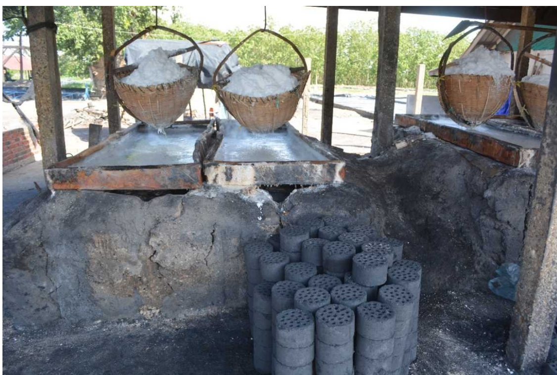
写真 一般的な製塩炉外観（写真は練炭を使用）
