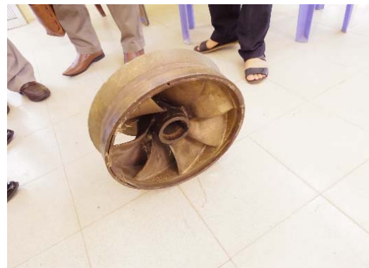
(写真 4-19: 改造のため、取り外されたインペラー)
