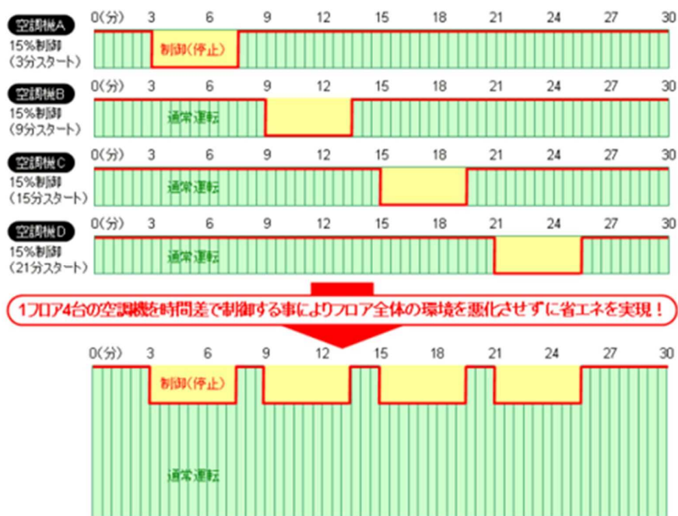
図 3. 1. 5 空調機 4 台に Be One を設置して連動させたコントロール例
