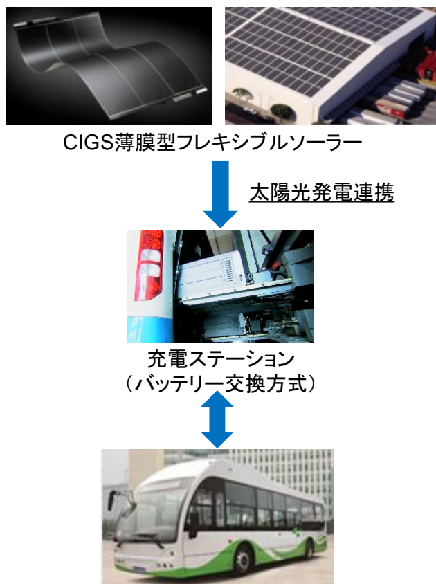
図 4-1 ゼロエミッション型・バッテリー交換方式 EV バスのイメージ
