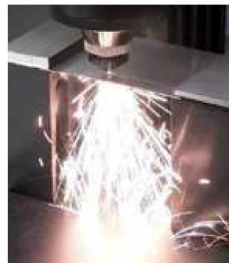
写真 ファイバーレーザによるステンレス鋼板切断の様子
