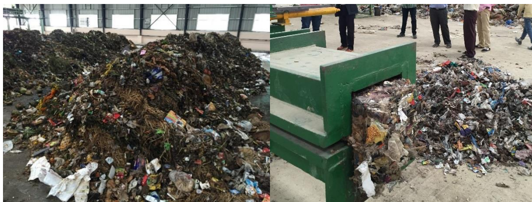
図 3-18：コンポスト化される有機性廃棄物（左）、ベイル化されるプラスチック残渣（右）
