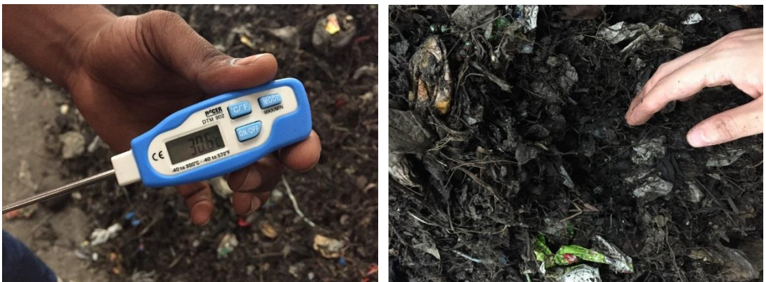
図 3-11：堆肥過程温度（左）と最終コンポスト（右）温度が十分に高くなく、最終コンポストも未熟である
