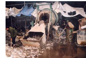
↑ アルミ・スクラップを洗浄する機械および、アルミ・スクラップを原料として、インゴットを製造する炉。浙江省台州市2002年11月。
