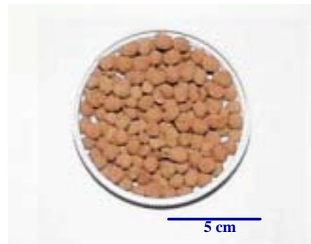
写真 6-1-1 多孔質ヘドロセラミックス担体
